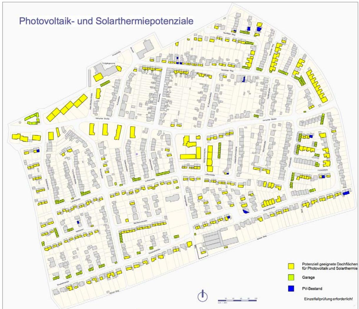
Abb. 22: Eignung der Dächer für PV oder Solarthermie
