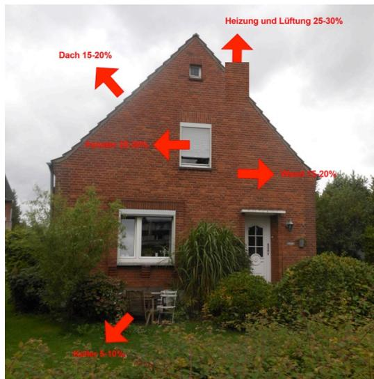
Abb. 21: Durchschnittliche Wärmeverluste über die Gebäudehülle<sup>8</sup>
