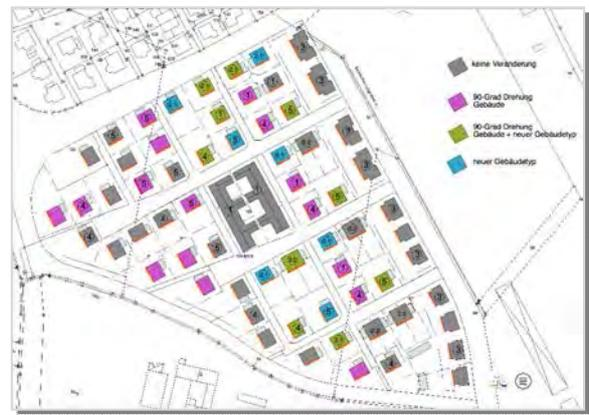
Solarenergetische Optimierung des Ausgangsentwurfs
